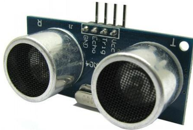
شکل ۲. ساختمان ماژول فراصوت اندازه گیر فاصله HC-SR04
